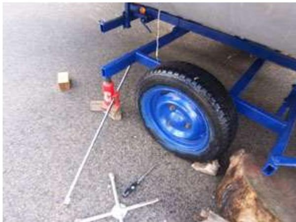
La pression interne du pneumatique « tubeless » portée à 4 bar permet de constater une légère fuite entre la jante et le pneu localisée en un endroit précis. Une bonne nouvelle cependant : « frère » LUC (fournisseur d'huile et de miel de la communauté des Morses de Callelongue) est en mesure de remédier au problème.
